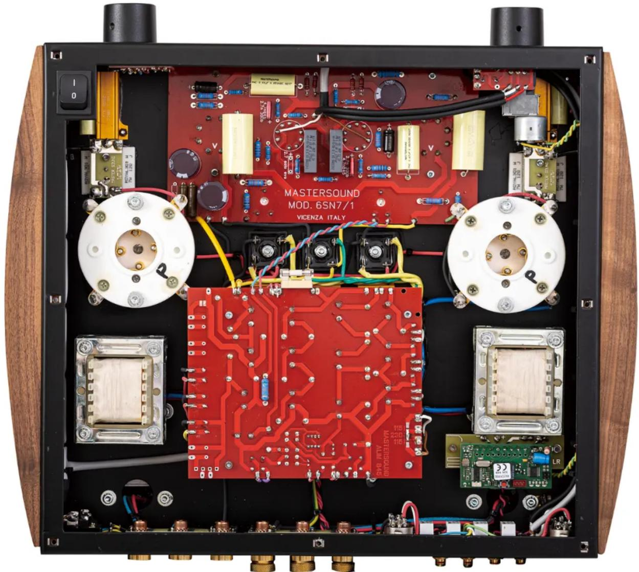
虽然变压器外罩是圆形的，打开内部就能发现，输出变压器仍是传统的EI型
